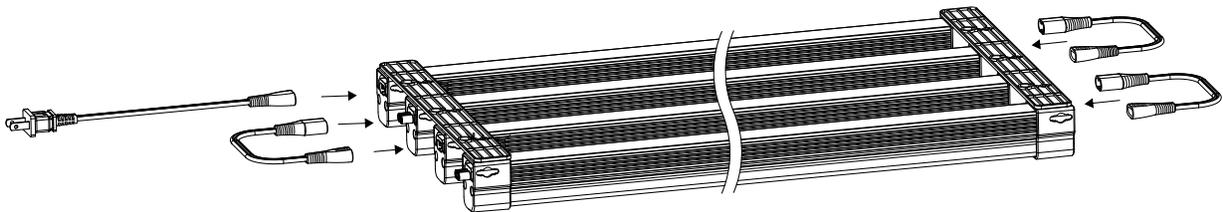
**5** Installez les câbles suspendus sur les supports de 12 pouces. Fixez ensuite l'autre extrémité des câbles de suspension aux crochets de suspension (non fournis) montés au plafond.
