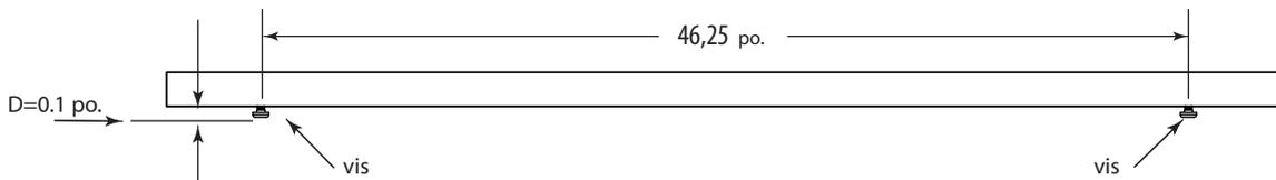
Dimensions de vis recommandées: Tête: 0,27 ~ 0,34 po., Vis: 0,16 ~ 0,17 po.
